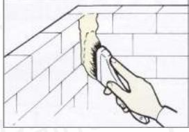
11 ローラーで塗りのばします。(A液とB液配合後2時間以内に使い切ってください。)
