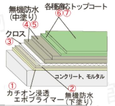
**1** 下地素材(コンクリート・モルタル)表面に形成されるレイトランス(遊離アルカリ)エフロレッセンス(白華)、ホコリ等は、ポリリッシャー等で完全に除去し、油分など付着物は、洗浄除去し、十分に乾燥させて下さい。
