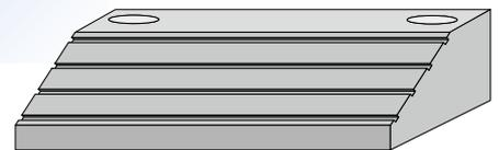
車止めの設置施工はエポキシボンド接着、もしくは取り付け金具を用いて設置してください。防水層に取り付け用の穴をあける場合は、取り付け時の防水処理を確実に行ってください。
