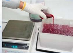
タフシール#50に硬化剤を混合してください。(硬化剤1~2%混合)
