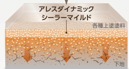
反応エポキシ樹脂の高い浸透力と毛細管現象で新生瓦など脆弱な下地層内から頑固に強化。
