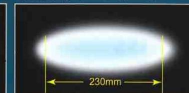
測定条件：● 手元圧力=0.2MPa ● バターンツマミ/チーターバルブ=全開
